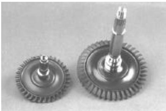
図7 セラミックタービンローター<sup>6)</sup>
