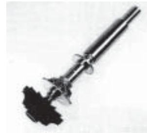
図4 圧縮機・タービンローターの構造 10)
